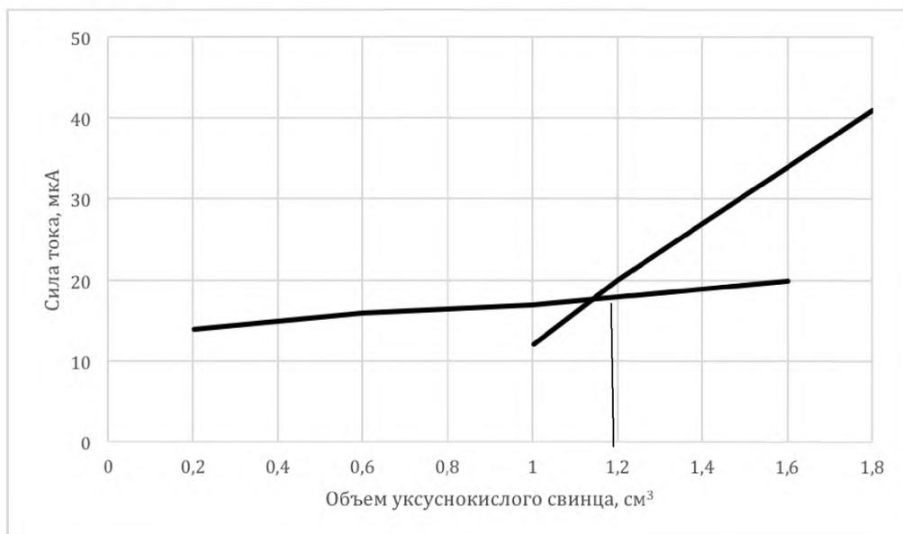
Рисунок 1 – Графическое определение точки эквивалентности для расчета массовой доли альфа-кислот
